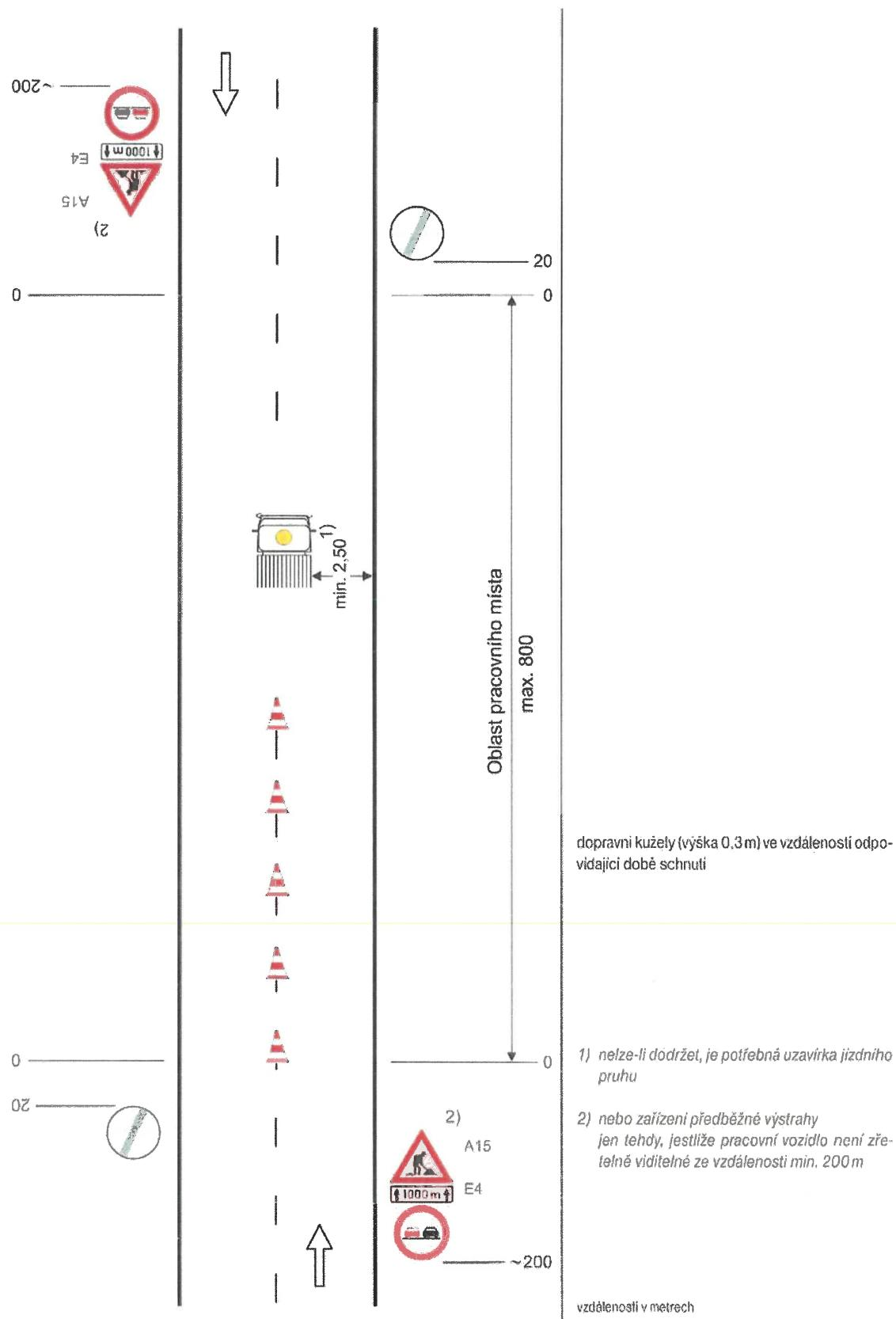
**Schéma č. 4.2.: Provádění vodorovného dopravního značení – místo s krátkou dobou provádění prací**
